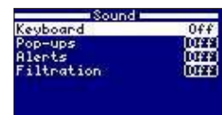
10.9 Ljud: Programmera systemet för att avge ljud för följande funktioner: Tangentbord (tangenter); Meddelanden (pop-upmessage); Alarm (driftsalar); Filtrering (filtreringsstart).
