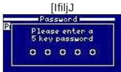
10.11 Lösenord: Skyddar användaråtkomst till menyn genom att aktivera ett lösenord. Tryck på en kombination av 5 knappar och systemet kommer att memorera den. Om du glömmer lösenordet finns det ett "huvudlösenord". Fråga din installatör/leverantör.
